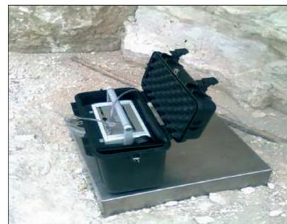
Figura 2. Radonometru RTM 1688-2.
